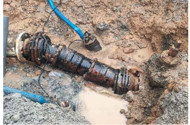
地震により伸縮許容範囲を超え、漏水した配管
